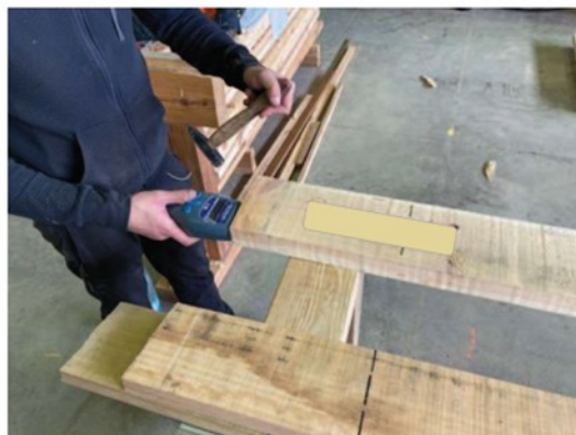
Figura 3. Ensayo con el MTG en una pieza de eucalipto testigo
