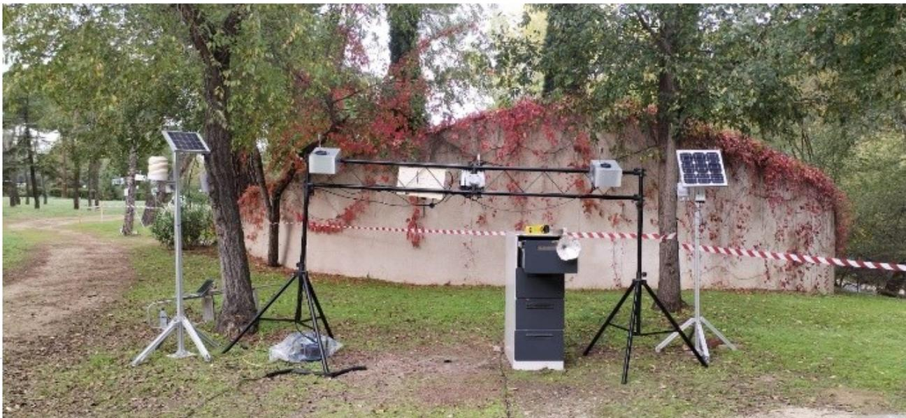
Figura 3. Ensayos en túnel de viento: Aspecto de la disposición de los módulos con los sensores y de uno de los ensayos realizados con ramas con acículas verdes de Pinus pinea.
