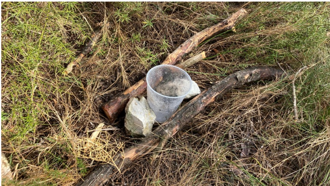
Figura 15. Pluviómetros físicos (analógicos) empleados para corroborar y calibrar pluviómetros e higrómetros digitales. Fuente: Medi XXI GSA
