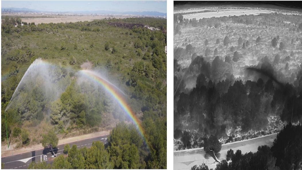
Figura 1. Reducción de la temperatura en zona de impacto de incendio forestal contra zona poblada mediante riego prescrito captada a través de cámara en espectro visible e infrarrojo en el Parque Natural de la Devesa del Saler – Albufera de València. Fuente: Bombers de València
