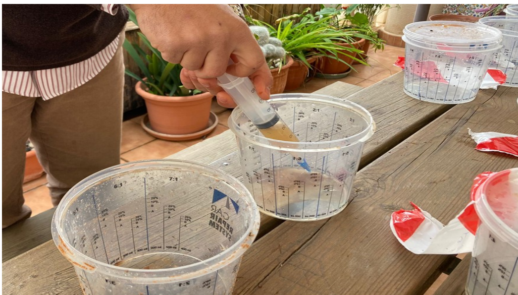
Figura 16. Comprobación al milímetro de la precipitación recogida en cada pluviómetro tras los riegos prescritos. Fuente: Medi XXI GSA
