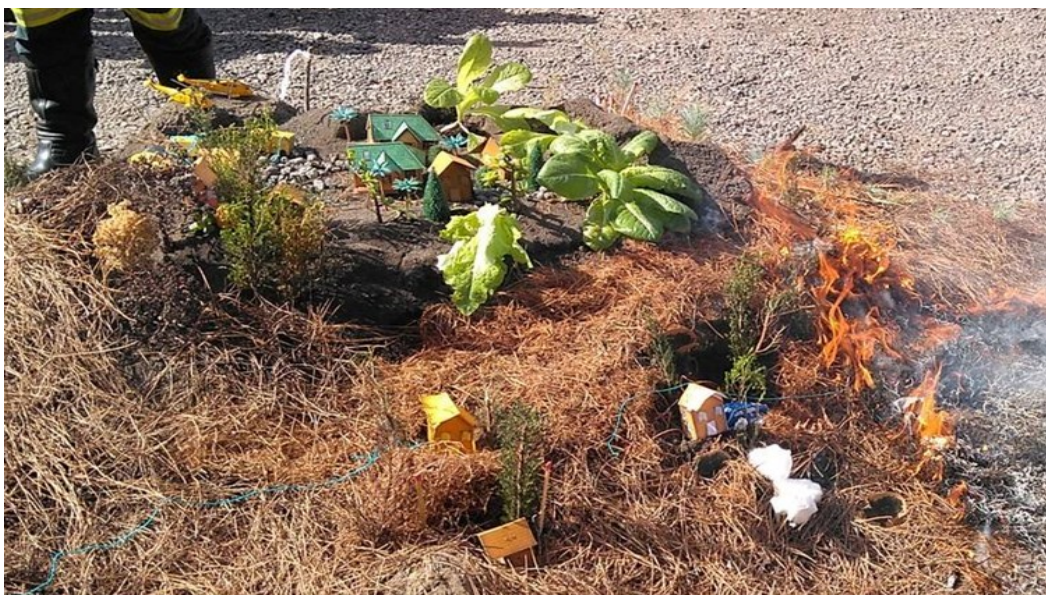
Figura 6. Simulación física a escala del impacto contra cortafuegos verde alrededor de una zona de I-UF de un frente de llama consolidado. Se combina vegetación viva y vegetación muerta. Para replicar el efecto de los riegos de ensanche se utilizaron atomizadores de agua con aditivos y sin aditivos. Fuente: Medi XXI GSA, 2019
