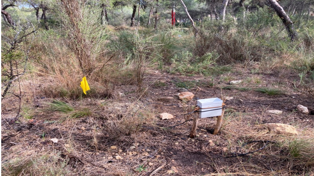
Figura 14. Instalación de higrómetros y pluviómetros bajo la zona de influencia de los riegos prescritos dentro del área de los cortafuegos verdes. Fuente: Universitat Politècnica de València.
