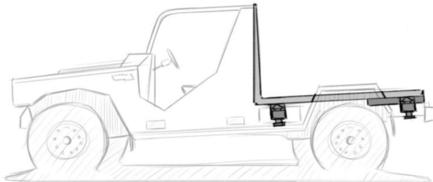
**OPCIÓN C** - para lograr una alternativa más equilibrada entre la robustez y la sencillez anteriores se ha diseñado un módulo que incluye esquinas normalizadas solamente en la base del módulo. Se ha diseñado con una estructura tubular de refuerzo que permite además la adición de diversos accesorios exteriores (Figura 7).
