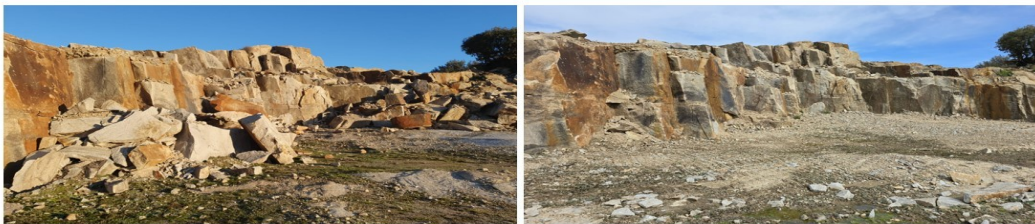
Figura 7. Izquierda: aspecto de un antiguo frente de explotación en su estado de abandono. Derecha: aspecto del mismo frente tras haber sido remodelado con una aproximación geomorfológica
