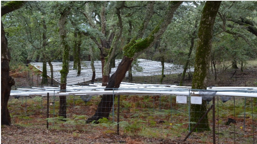
Figura 1. Infraestructura de exclusión de lluvia en una de las zonas de estudio
