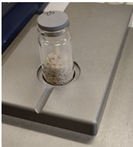
Figura 1. Adquisición de los espectros de las muestras perforadas en viales de vidrio (FBruker) mediante un NIR MPA.
