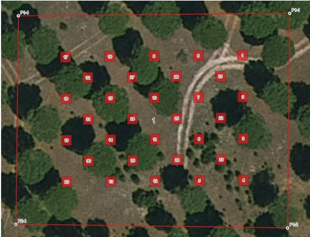
Figura 2. Ejemplo de Replanteo de las 32 subparcelas de 3x3 m para la parcela 1, este esquema se repite en cada una de las otras 5 parcelas
