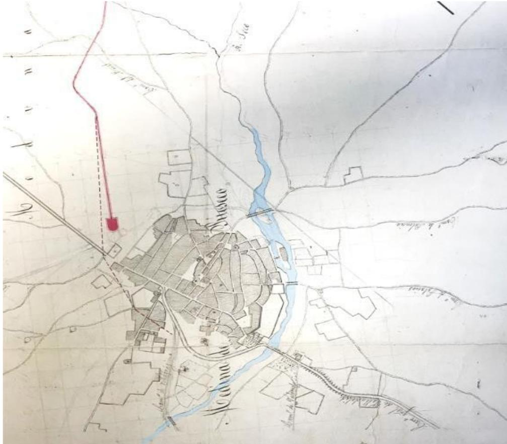
*Figura 3. Fragmento del plano del brazo del Canal de Campos comprendido entre Villanueva de S. Mancio y Medina de Rioseco, 1846. 1848. Se observa el cauce del río remarcado en color azul (grafado por M. R. del Caz), las dos islas y los 4 puentes referidos. El canal de Castilla está en el original en rojo. Fuente: Archivo de la Confederación Hidrográfica del Duero (CCHPRC286-01-1846).*
