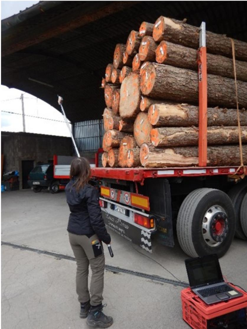
*Figura 4. Imagen del proceso de lectura de tarjetas RFID en el camión forestal*
