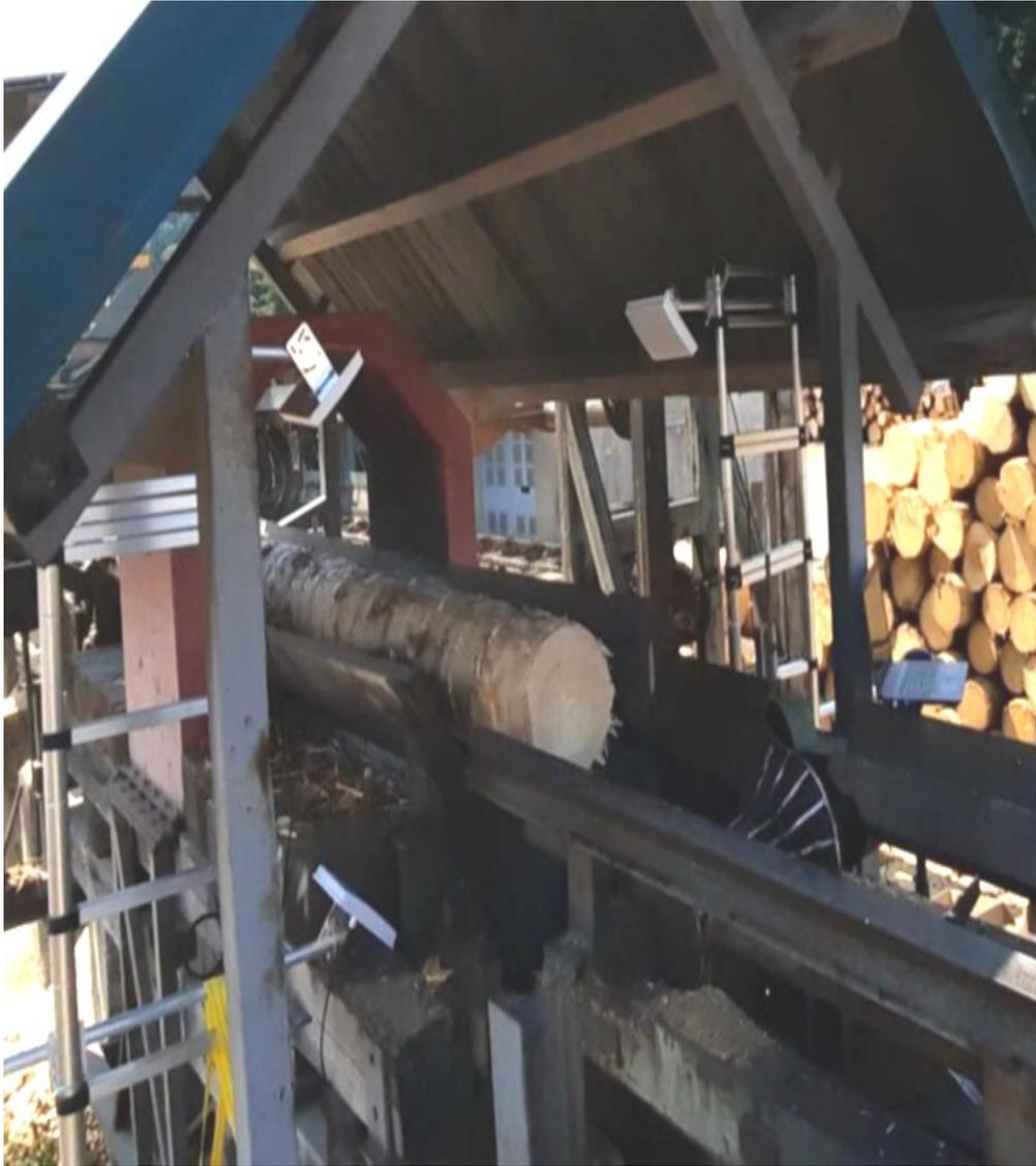
*Figura 3. Imagen de la disposición de las antenas para la lectura en la línea*
