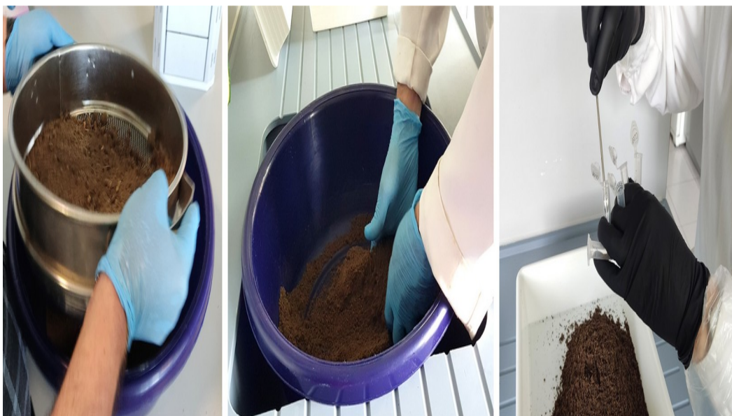
Figura 2. Tamizado (izquierda) y mezcla (centro) de muestras de suelo para obtener el suelo tamizado, que luego fue dividido en alícuotas (derecha).
