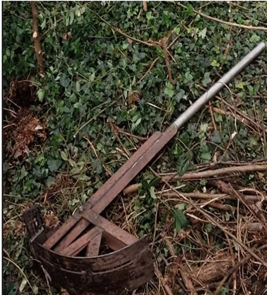
*Fotografía 18. Herramienta manual para arrancar Acacia melanoxylon fabricada por la Comunidad de Montes de Coiro*
