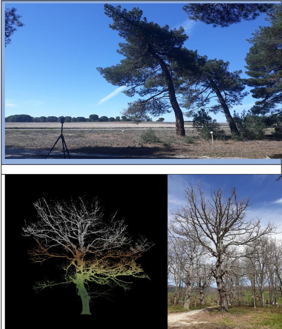
Figura 1. Proceso de escaneo en campo con FARO Focus3D M70 junto con las esferas de referencia de un ejemplar de *P. pinaster* (superior); comparativa nube de puntos-fotografía de un ejemplar de *Q. pyrenaica* (inferior).
