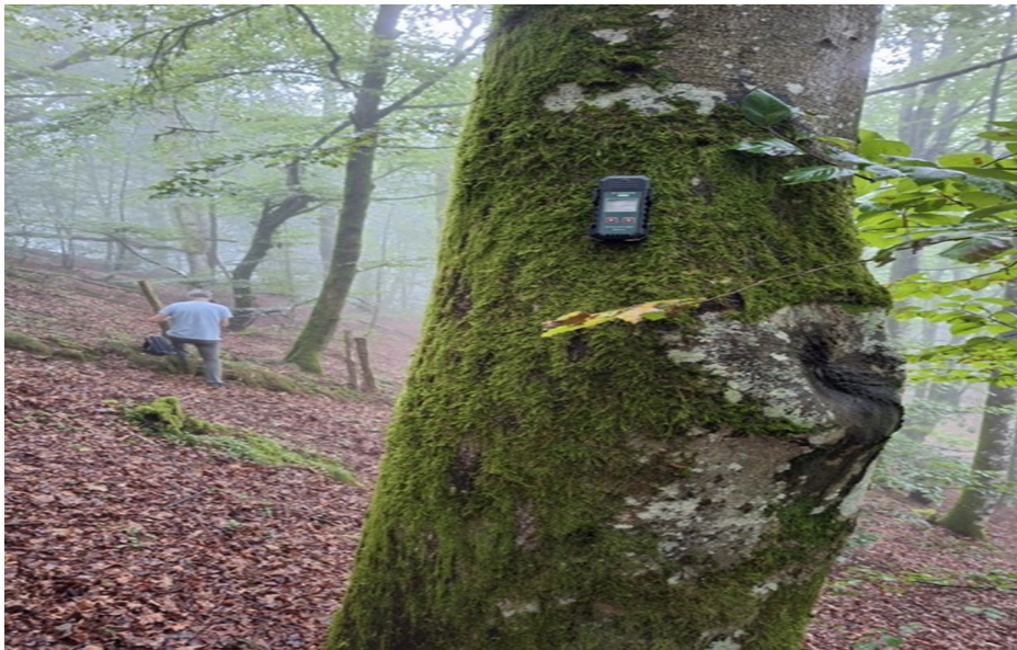
Figura 6. Instalación de una grabadora de ultrasonidos en el suelo y de una estación climatológica en una de las hayas de los rodales muestreados.
