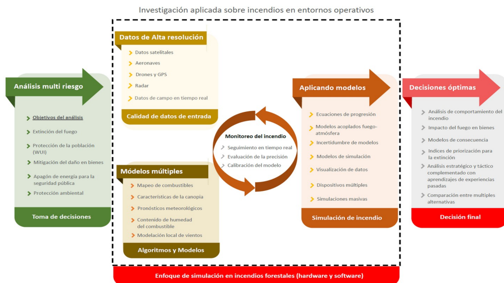
Figura 1. Enfoque de simulación de incendios, que incluyen capacidades mejoradas de modelización de incendios gracias a la gran calidad de los datos de entrada, la mejora de los modelos y algoritmos, y el seguimiento preciso de los incendios. Esto permite a los organismos tomar decisiones en entornos operativos basadas en análisis multirriesgo y objetivos específicos.
