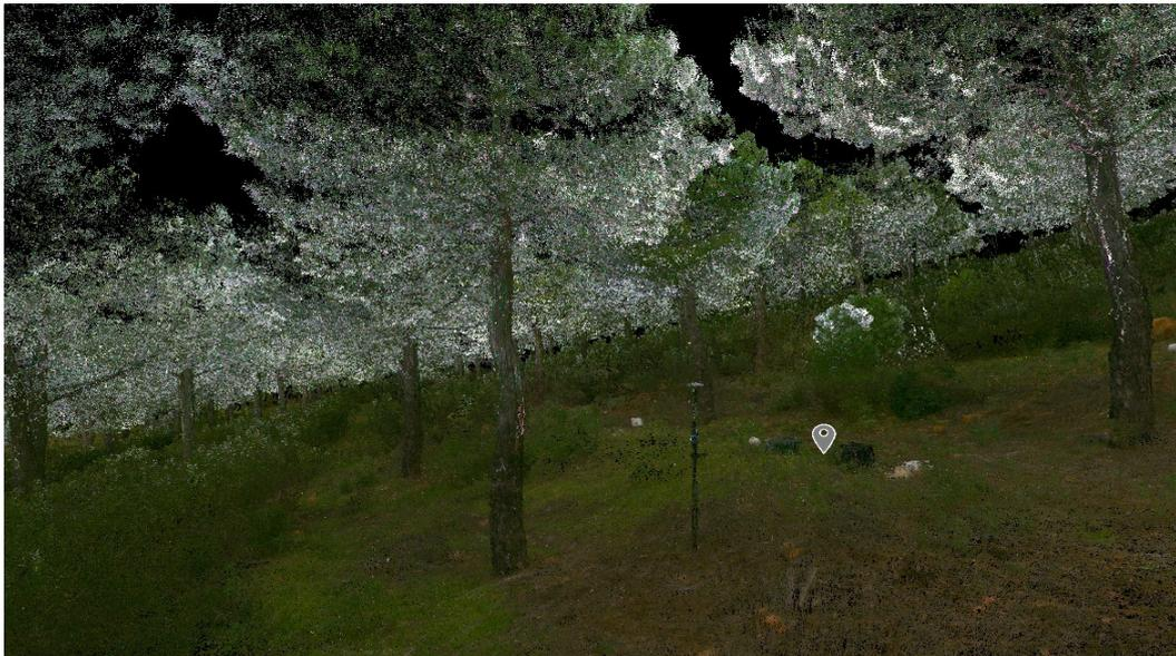
*Figura 6. Nube de puntos procedente de Sistema Láser Terrestre (TLS) de una masa de repoblación de Pinus pinea sometida a tratamientos selvícolas.*
